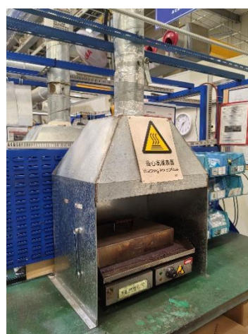
小齿轮电加热油雾废气集气罩收集(电热板上)
